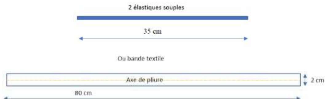
Figure 8 —à plis - Dimensionnement du jeu de brides
